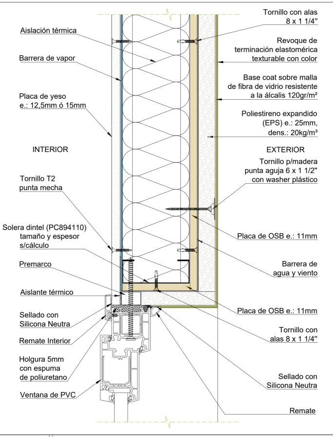
SISTEMA LIGH-STEEL FRAMING DETALLE REVESTIMIENTO EIFS. Encuentro con carpintería de PVC.
