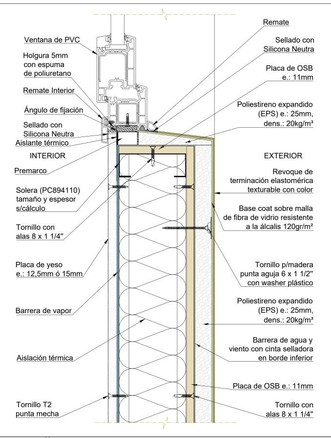
SISTEMA LIGH-STEEL FRAMING DETALLE REVESTIMIENTO EIFS. Encuentro con carpintería de PVC.
