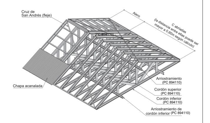
La rigidización se realiza con cruces de San Andrés cuando la separación de la cabriadas es mayor a 0,60m o cuando la cubierta a instalar no necesita sustrato.
